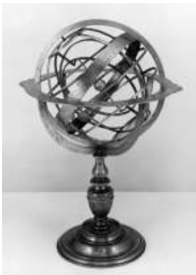
Esfera armilar de bronce del siglo XVI, con los círculos del Sol y de la Luna, y el eje central a través de los polos; compáraselos con la descripción del sistema planetario del «Mito de ER» de Platón (Toulmin, Stephen y June Goodfield. «La trama de los cielos». Buenos Aires, Eudeba, 1963).
