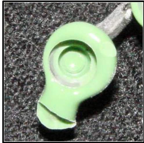
Fig. 26 Zona de sobrecontacto.
