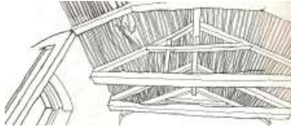
Fig. 14 y 15.- Tijerales rollizos y azuelados
