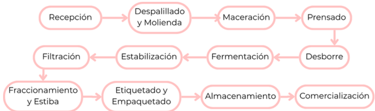
Figura 9 - Diagrama general del proceso de producción de vino rosado. - Fuente: elaboración propia.
