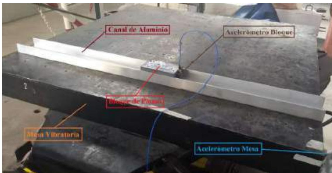
Figura 5.14. Esquema general de ensayo de bloque deslizante sobre canal plano de aluminio (Barlek et al. , 2021).
