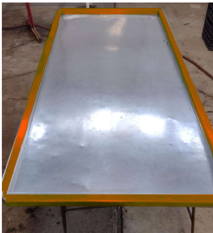
Figura. 5: Mesada de trabajo con indicación de color para uso en etapas de limpieza, selección y retoque. (zona sucia)
