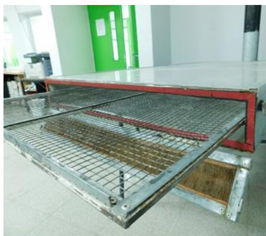
Figura 3.5: cámara, puerta carga/descarga abierta con las bandejas de secado.
