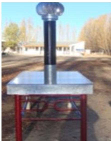
Figura 3.1: secador solar eólico en funcionamiento
