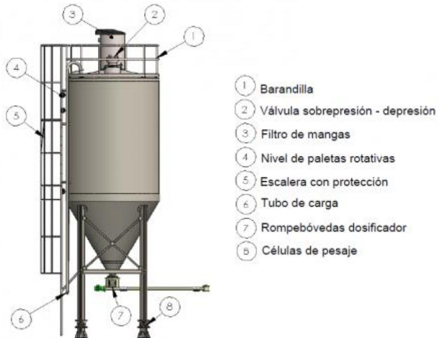
Figura 9-2 Esquema silos de almacenamiento
