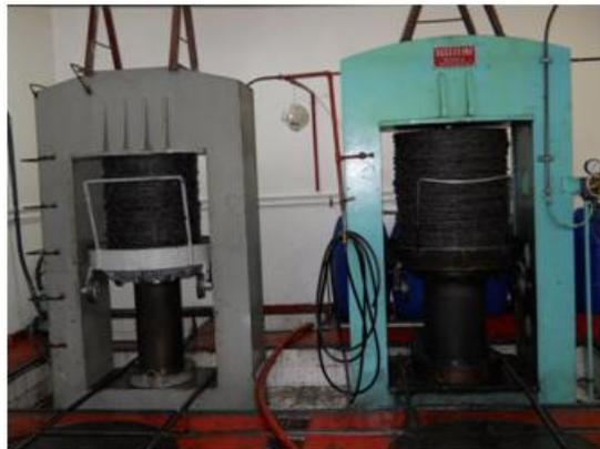
Foto 13: Prensa hidráulica
