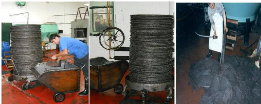
Fotos 14, 15 y 16: Torre de prensado: armado con esportines -cubiertos con pasta de aceitunas- en el carro guía; limpieza del orujo agotado. Fuente: propia, 2011
