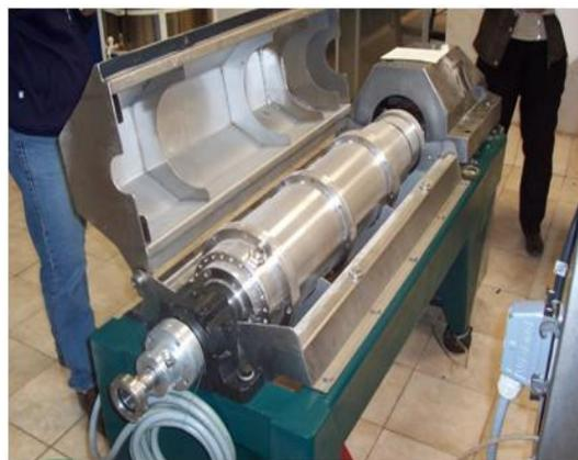
Fotos 19 y 20: Línea continua de dos fases y decanter o centrífuga separadora horizontal.
