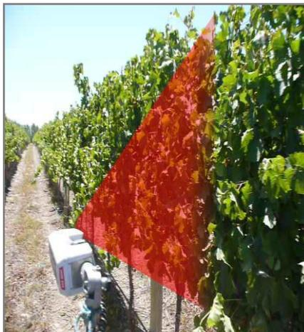
**Figura 2: Modo de Relevamiento de Datos NDVI con Greenseeker.** Sobre la imagen se indica con transparencia roja el haz de energía emitida por el sensor.
